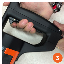
Fig. 1 - Agire con il dito indice il grilletto e alzarlo in alto fino a sentire il blocco meccanico.
