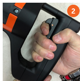
Fig. 3 - Si lascia flottante e libero il ritorno. Rilasciando il pulsante, deve ritornare in posizione OFF da solo.
