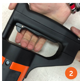
Fig. 1 - Agire con il dito indice il grilletto e alzarlo in alto fino a sentire il blocco meccanico.
